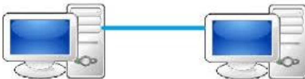
Figura 43: Conexão de computadores na rede Ponto-a-ponto.
