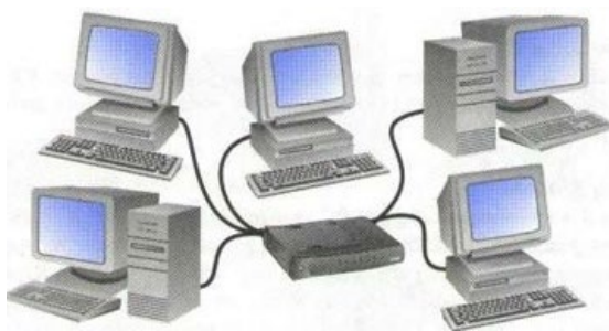
Fig. 74 – Rede de computadores com switch
