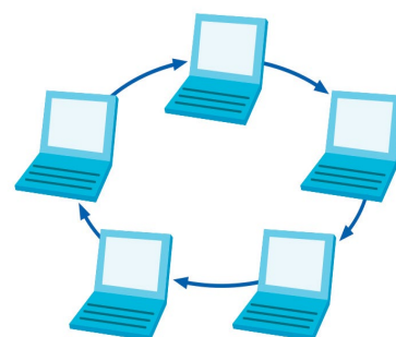
Fig. 89 - Topologia de rede em anel
