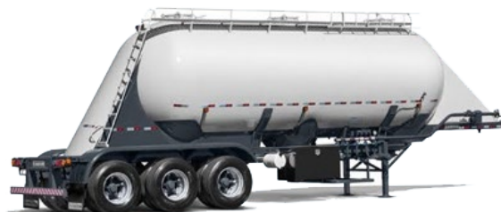
Fig. 44 – Granel para consumidores que possuem silos de armazenagem
