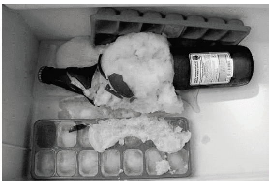
Fig. 12 – Dilatação de líquidos
